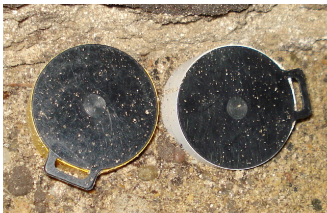
1. ábra. ^{222}\text{Rn} - és ^{220}\text{Rn} - aktivitáskoncentráció mérése talajfelszínre kihelyezett Radamon detektorpárral (tényleges méret)
