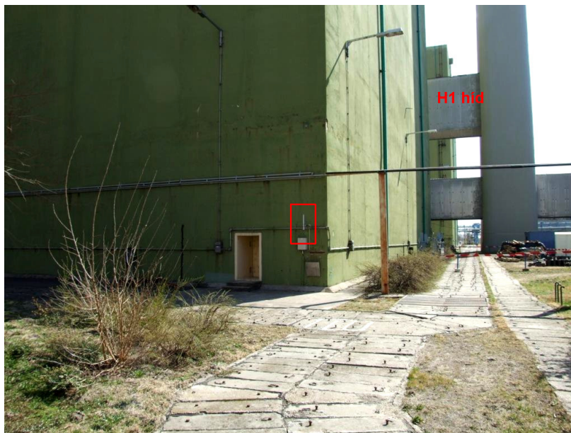
15. ábra. A csóvadetektlás szempontjából nem ideális elhelyezésű udvartéri detektor, amely csak részlegesen tudja a szellőzőkémény csóvját mérni. A detektor a piros téglalapon helyezkedik el. A kép jobb oldalán látható a szellőzőkémény alsó része és a H1 szellőzőhíd.
